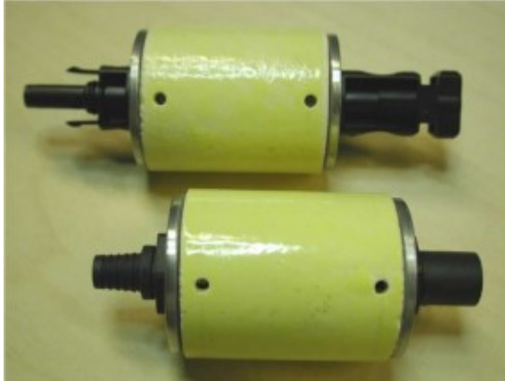
Abbildung 4: Darstellung thermische Sicherung für Photovoltaikmodule
